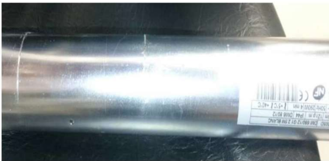
TUBO DE MOTOR RAYADO O CORTADO
