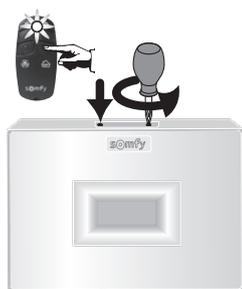
**2** Desconecte el cable de alimentación eléctrica y la toma RJ 45 en el interior de la central. Quite 1 pila.
